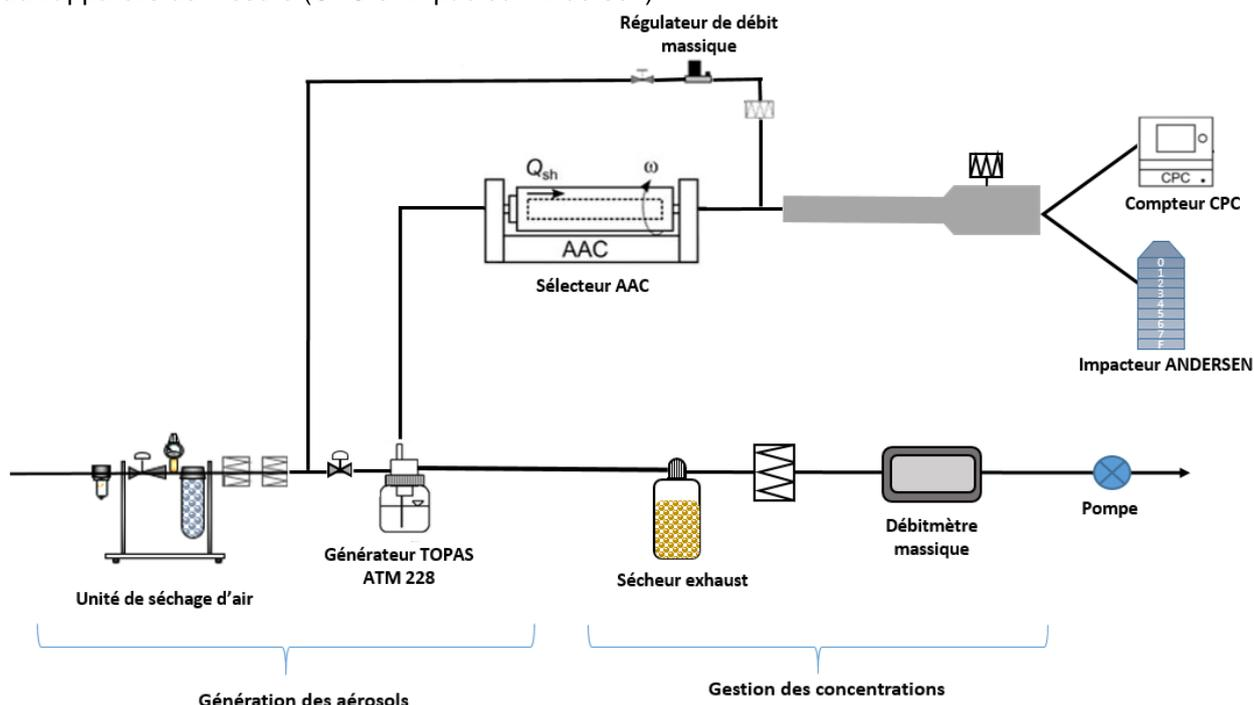
Figure 1: Disposition du banc BARMAN en configuration de qualification d'impacteur ANDERSEN
