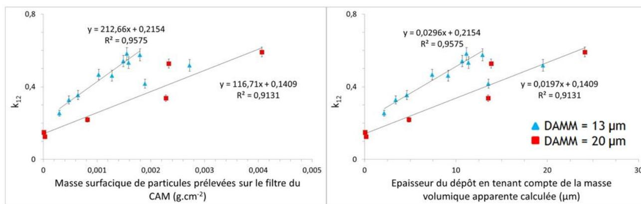
Figure 2 : Évolution du coefficient  $k_{12}$  en fonction de la masse surfacique de particules prélevée sur le filtre du CAM (à gauche) et en fonction de l'épaisseur du dépôt en tenant compte de la masse volumique apparente calculée (à droite). Les triangles bleus représentent les mesures effectuées avec DAMM = 13  $\mu\text{m}$  et les carrés rouges celles avec DAMM = 20  $\mu\text{m}$
