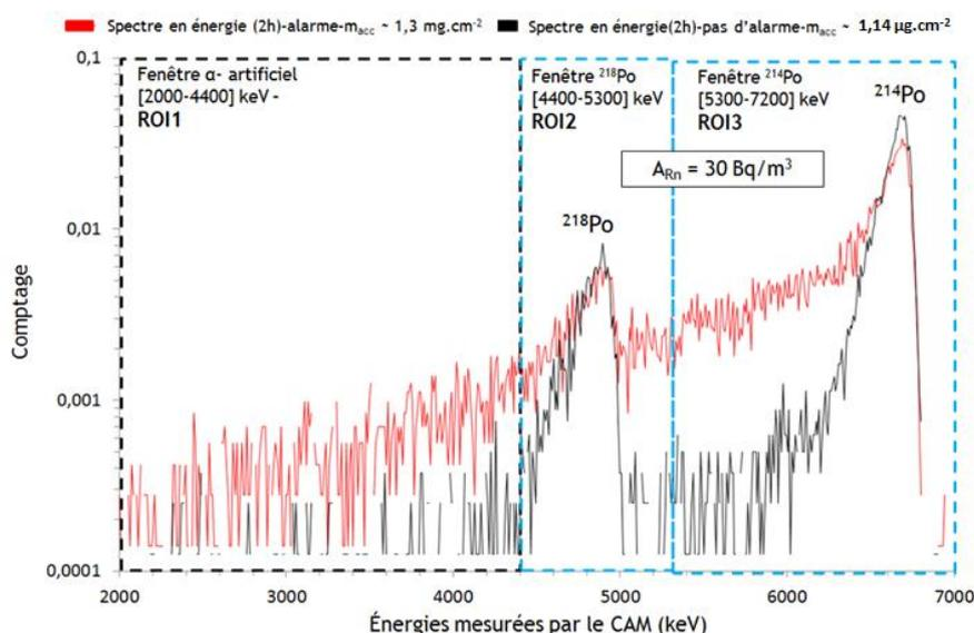
Figure 1 : Deux spectres en énergie mesurés par le CAM, avec (rouge) et sans (noir) dépôt d'aérosols
