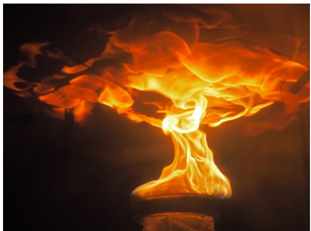
Figure 1 : Flamme impactante. Fort effet des flux thermiques rayonnés sur la combustion.
