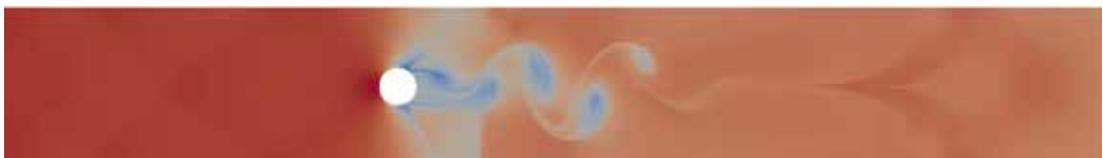
Écoulement obtenu lorsqu'un choc de pression violent heurte un cylindre
