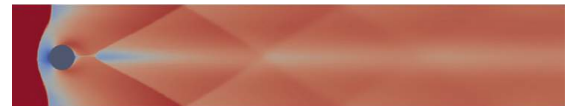
Simulation d'un écoulement en eau peu profonde derrière un cylindre
