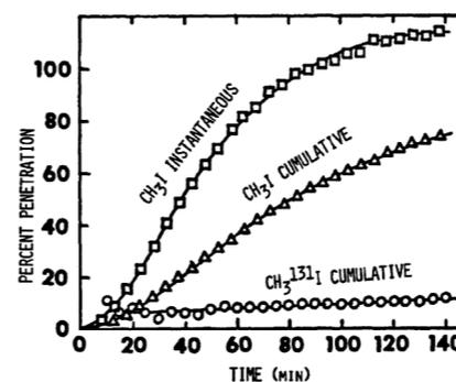
Comparaison de courbes de percée pour un même charbon actif standard, en iode radioactif et en iode non radioactif <sup>[1]</sup>
