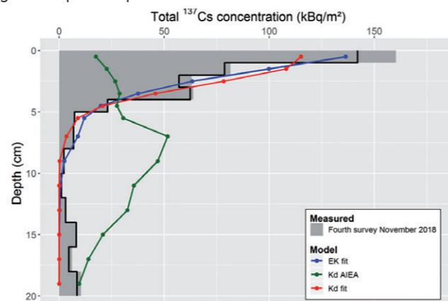
Distribution verticale du  $^{137}\text{Cs}$  ( $\text{kBq/m}^2$ ) dans la parcelle 1 en 2018 et les résultats du calage des modèles EK (bleu) et  $K_d$  (rouge). La courbe verte représente le profil simulé avec la valeur  $K_d$  proposée par l'AIEA pour un sol organique
