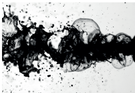
Spray en transition vers le flashing (Conditions : 5 mbar, 32^\circ\text{C} )
