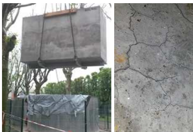
Figure 1: (a) maquette représentative d'un ouvrage massif (b) maquette fissurée.
