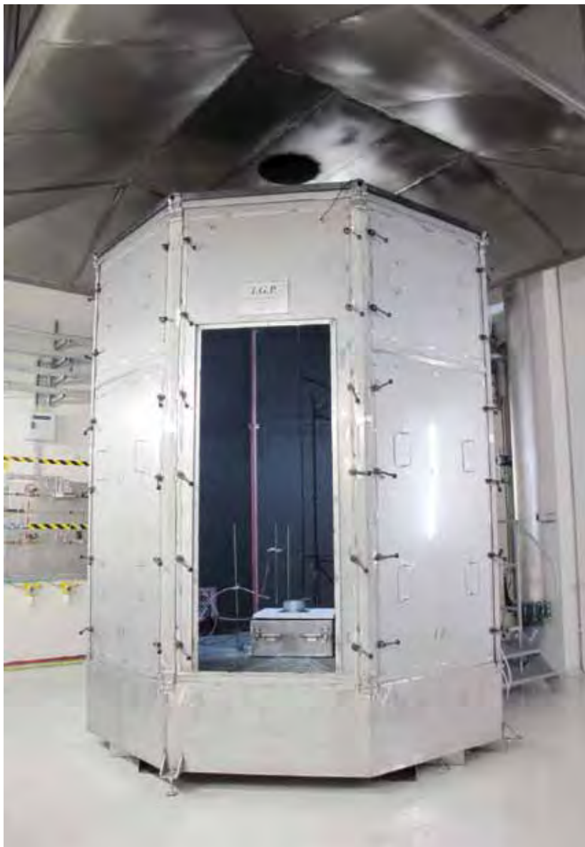
Figure 1. Calorimètre à atmosphère contrôlée: CADUCEE
