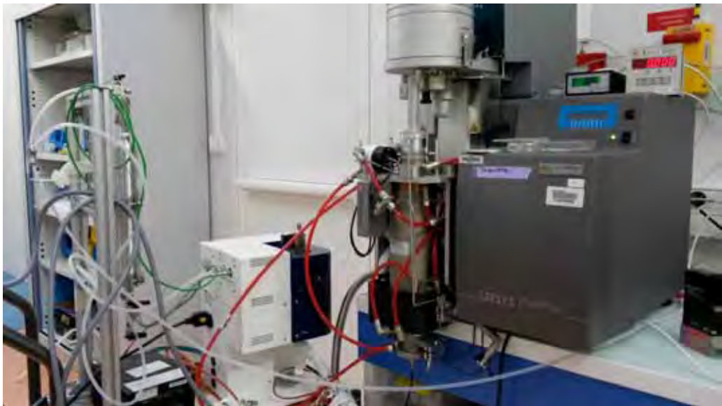
Figure 1. Appareil d'analyse thermogravimétrique (droite) couplé à un générateur de vapeur d'eau (gauche)
