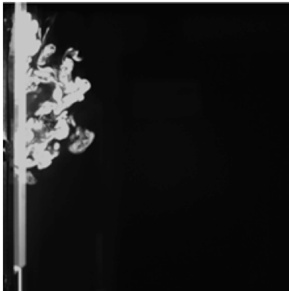
Visualisation Laser du phenomene de retrodiffusion sur une fente rectangulaire
