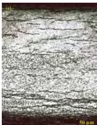
Figure 1. Coupe d'une gaine hydrurée (analyse post-mortem) X. Iltis et al. – NT CWL n°2005-75
