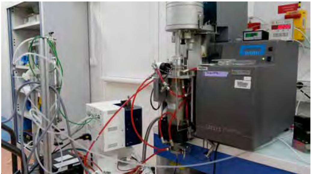
Figure 1. Appareil d'analyse thermogravimétrique (droite) couplé à un générateur de vapeur d'eau (gauche)
