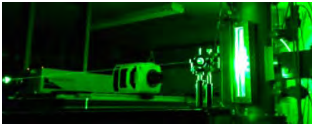
Figure 1. Système PIV Haute Fréquence à l'essai sur ENACCEF 1
