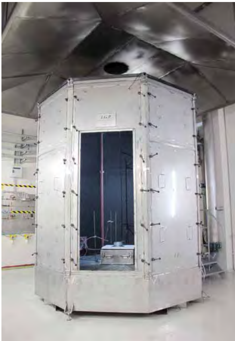
Figure 1. Calorimètre à atmosphère contrôlée: CADUCEE
