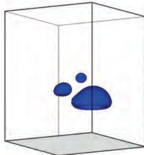
Figure 1 : Exemple de simulations tridimensionnelles diphasiques, montée de trois bulles de gaz dans une colonne de liquide
