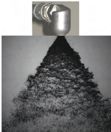
Buse d'aspersion de Réacteur à Eau Pressurisée et visualisation à l'aide d'une caméra rapide du spray en sortie de celle-ci.
