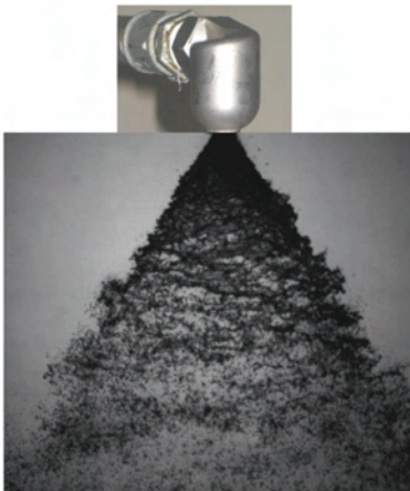
Buse d'aspersion de Réacteur à Eau Pressurisée et visualisation à l'aide d'une caméra rapide du spray en sortie de celle-ci.
