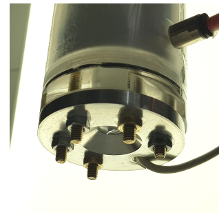
(e) Base du dispositif, prise de pression et orifice circulaire bouché.
