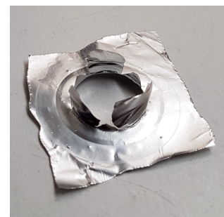
(f) Feuille d'aluminium obstruant initialement l'orifice à la fin de l'essai.
