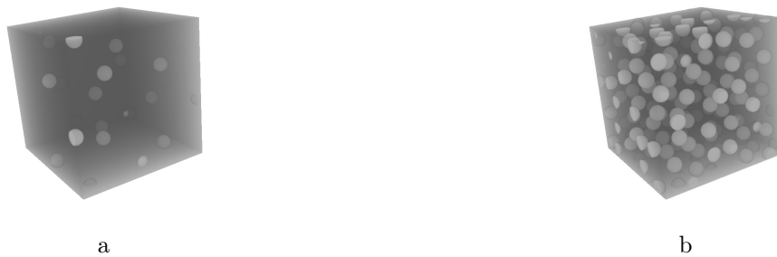
FIGURE 3.23 – Exemples de cellules unitaires périodiques avec cavités mono-dispersées en taille et non-interpénétrables pour les simulations par FFT : a) f = 0.01 , b) f = 0.1 . (Joëssel et al. , 2018).
