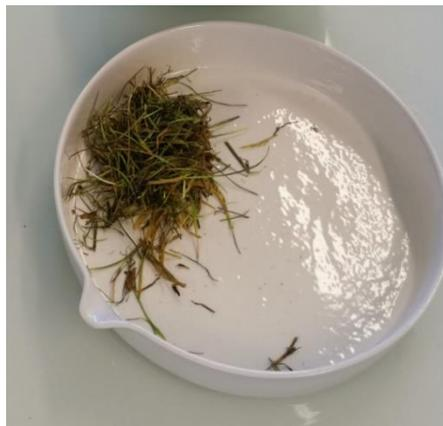
Figure II.13 : Ajout d'iode sous forme de KI à 20 g d'herbe placée dans un creuset.
