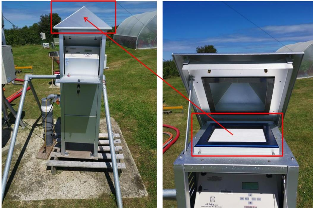
Figure V.2 : Dispositif de prélèvement d'air à haut débit ( $60 \text{ m}^3 \cdot \text{h}^{-1}$ ). A gauche : dispositif de prélèvement d'air sur filtres. A droite : agrandissement de la zone de contenance des filtres pour la collecte des aérosols atmosphériques.
