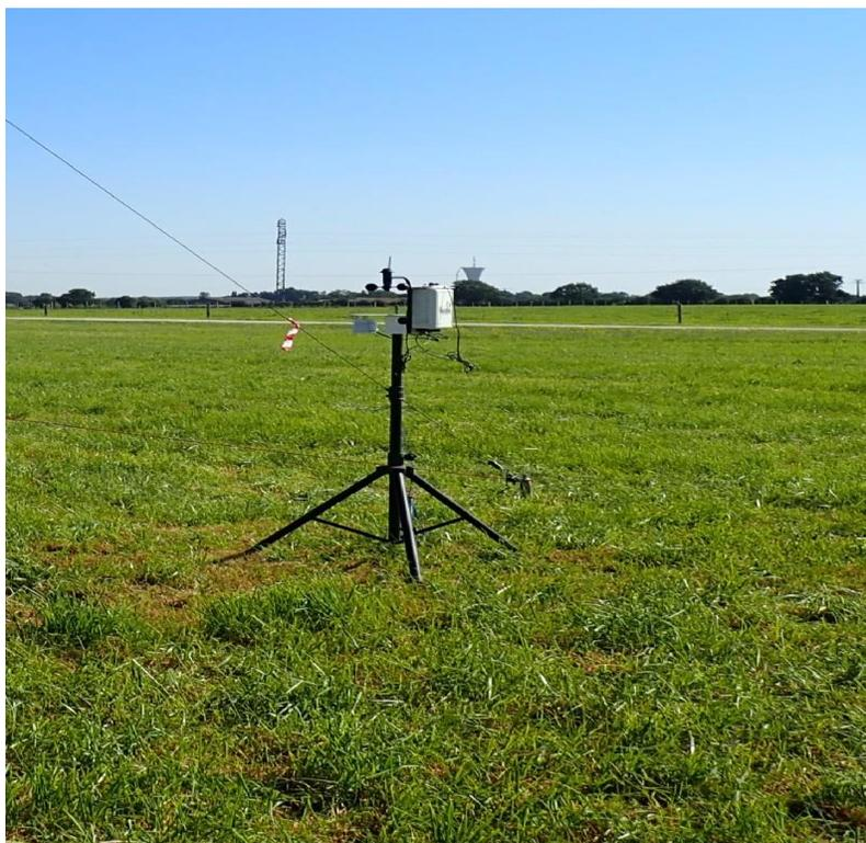
Figure II.16 : Station météorologique (WatchDog 2000 series) implantée à 1,5 m au-dessus du sol au niveau du site de l'INRAE à Lusignan.
