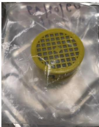
Figure V.7 : Cartouche placée dans l'AS 3000 pour le prélèvement d'<sup>129</sup>I gazeux.
