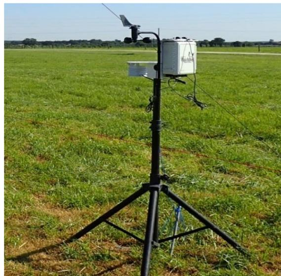
Figure IV.3 : Disposition de la station météorologique monté à 1,5 m au-dessus du sol lors de la campagne MIOSEC 1.
