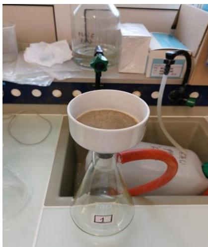
Figure II.11 : Dispositif de filtration utilisé.
