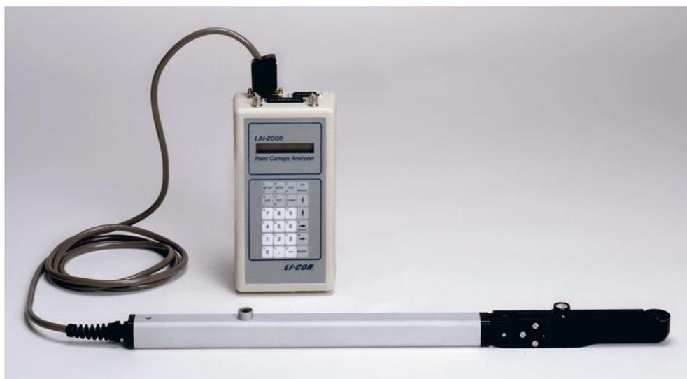
Figure II.15 : LAI-mètre pour la mesure de la LAI (Li-Cor, LAI-2000).
