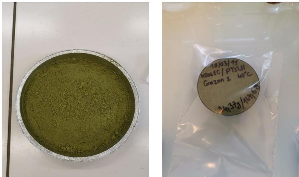
Figure V.9 : Herbe broyée après séchage à 40 °C et son conditionnement. A gauche : herbe broyée après séchage à 40 °C. A droite : conditionnement de l'herbe broyée dans une géométrie de comptage b60.
