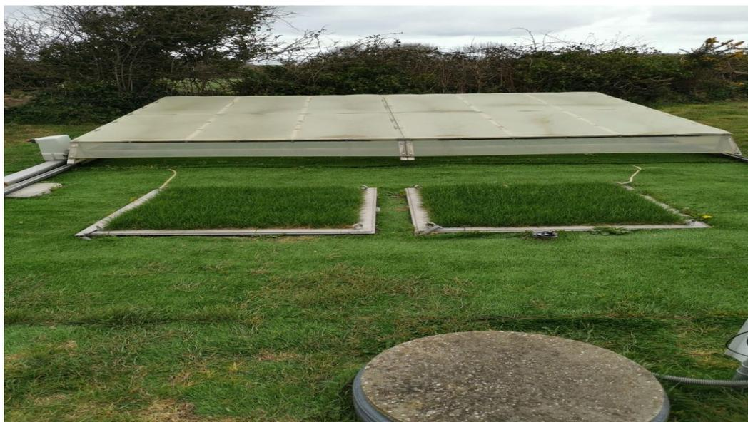
Figure V.8 : Présentation des lysimètres à toit découvrant par temps sec avec un système de fermeture automatique en cas de pluie, placés à la plateforme technique IRSN La Hague.
