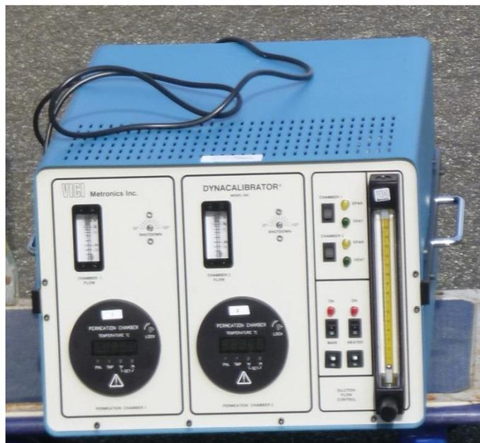
Figure II.2 : Générateur d'iode (Model 500 Dynacalibrator).
