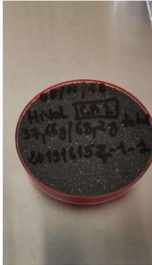
Figure V.6 : Conditionnement du charbon actif dopé de TEDA dans une géométrie de comptage b60.
