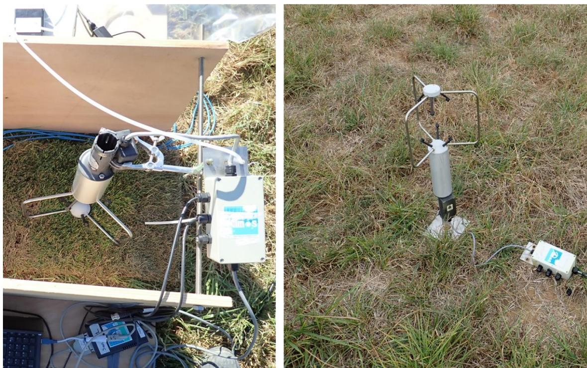
Figure II.17 : Anémomètre ultrasonique (Young, Model 81000) monté sur le site de l'INRAE à Lusignan. A gauche : disposition de l'anémomètre dans le canal lors de la campagne expérimentale de mise au point (à 0,1 m au-dessus du sol) (campagne MIOSEC 1). A droite : disposition de l'anémomètre dans l'environnement (0,5 m au-dessus du sol) (campagne MIOSEC 2 et 3).
