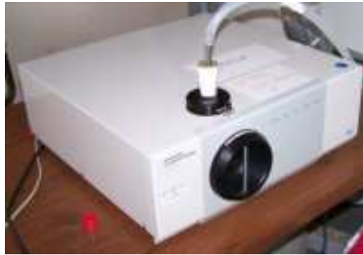
figure 192. Aerosizer utilisé pour déterminer des granulométries d'aérosols
