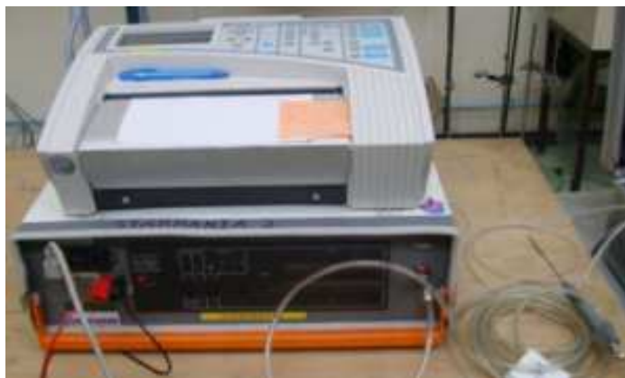
figure 187. Spectromètre de masse Alcatel, pour mesurer les concentrations en hélium dans l'air. Au-dessus : enregistreur Sefram ; à droite : sonde de prélèvement (capillaire permettant de réguler le débit vers la cellule de mesure du spectromètre)
