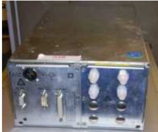
figure 188. Analyseur infrarouge Binos (société Rosemount) utilisé pour déterminer des concentrations en SF 6
