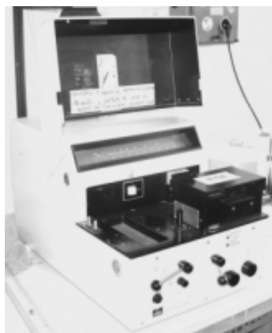
figure 189. Fluorimètre Eppendorf utilisé pour déterminer les masses d'uranine récoltées sur les filtres de prélèvement
