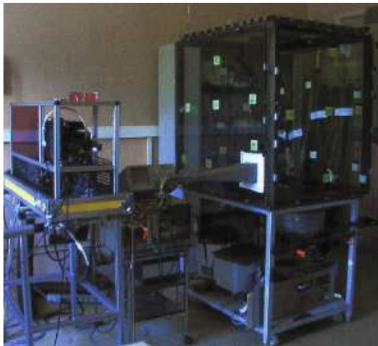
figure 98. Dispositif expérimental utilisé pour l'étude du dépôt d'aérosols dans une boîte ventilée de 0,8 \text{ m}^3 (Prévost et al. , 2001)
