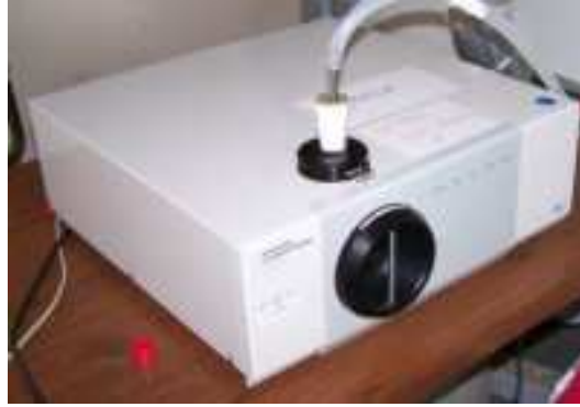
figure 192. Aerosizer utilisé pour déterminer des granulométries d'aérosols
