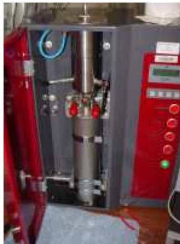
figure 193. ELPI utilisé pour déterminer des granulométries d'aérosols
