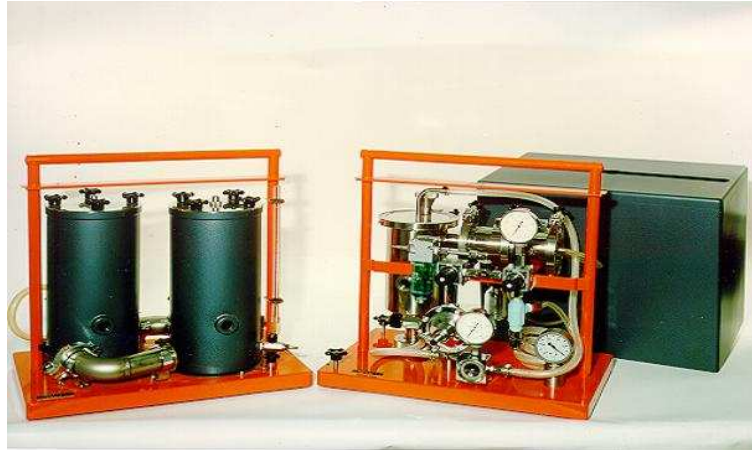
figure 177. Générateur pneumatique utilisé pour obtenir des particules de d_{ae} = 0,18 \mu\text{m}
