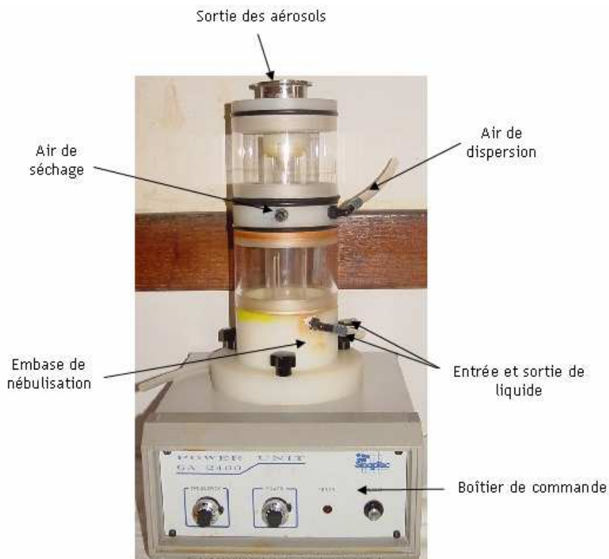
figure 107. Générateur d'aérosols à ultrasons GA 2400
