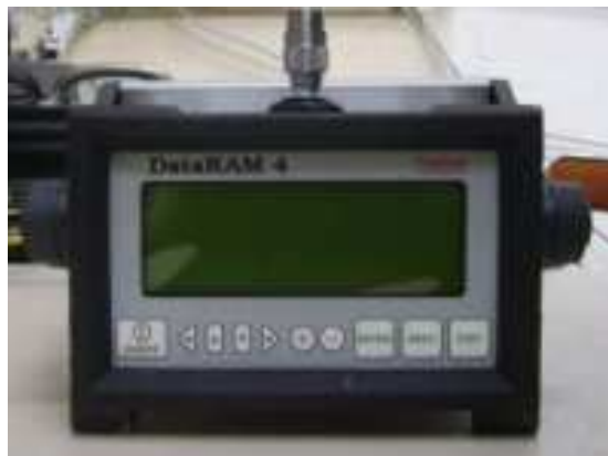
figure 190. Néphélomètre utilisé pour mesurer la concentration en particules à l'extraction d'air d'un local ventilé
