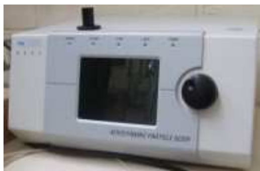
figure 191. Aerodynamic Particle Sizer (APS) utilisé pour déterminer des granulométries d'aérosols
