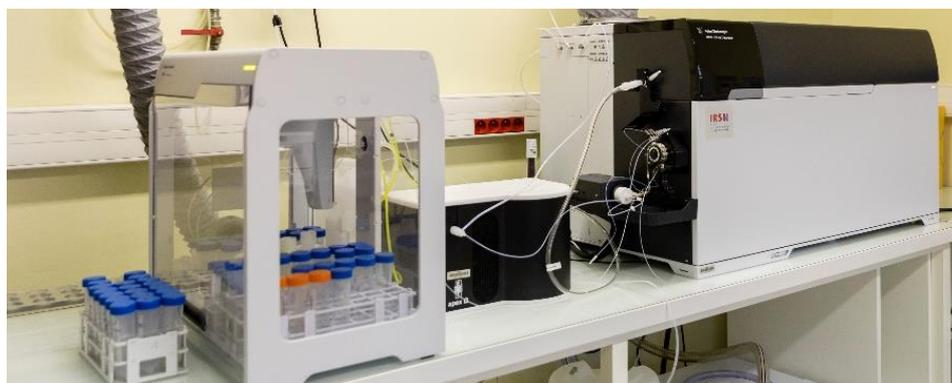
Figure IV- 10- Photographie de l'ICP-MS Agilent 8900 utilisé pendant cette thèse
