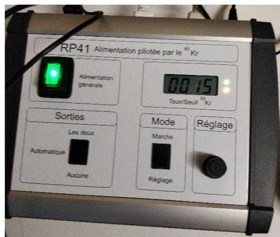
Figure V- 5- Déclencheur permettant de piloter les deux HVS en fonction du bruit de fond en  $^{85}\text{Kr}$
