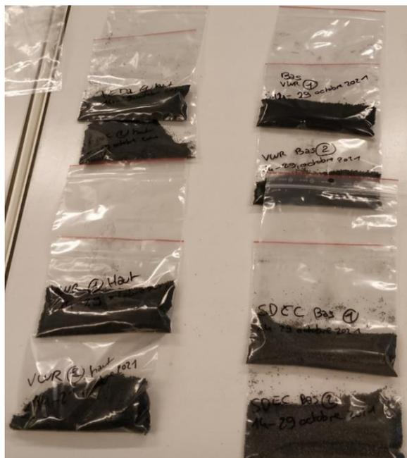
Figure V- 43- Sacs contenant les différentes couches de charbon
