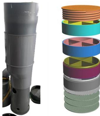
*Figure V- 2- Colonne de prélèvement fabriquée en PVC et superposition de cartouches dans la colonne*
