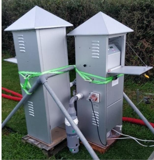
*Figure V- 1- Préleveurs automatiques installés sur la PTILH*
