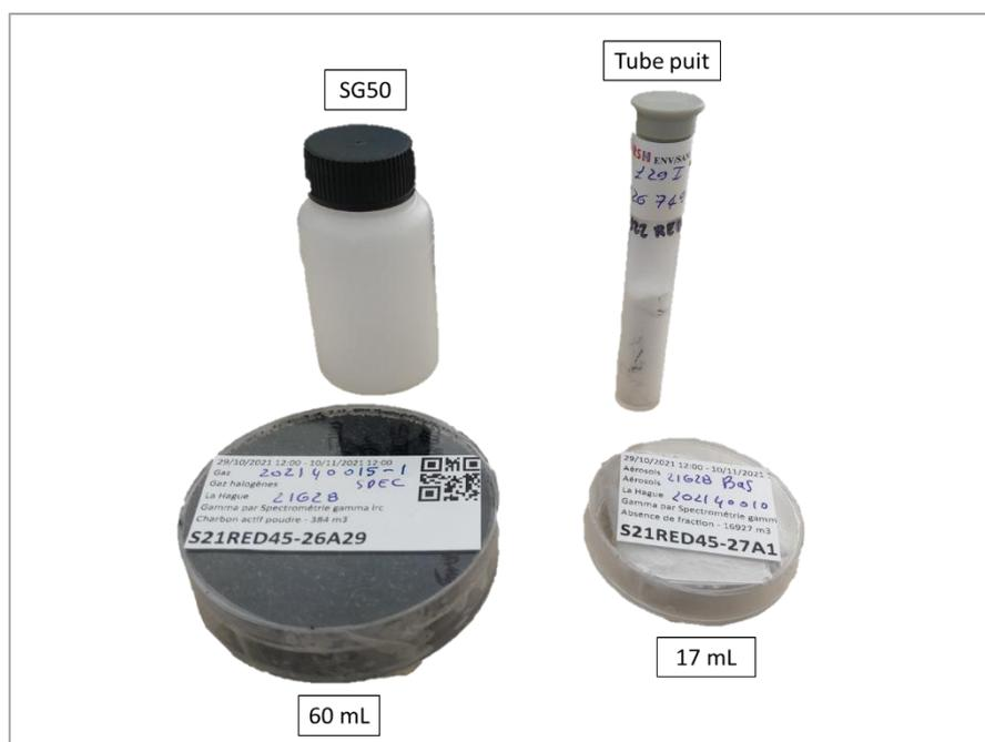
Figure IV- 12 - Géométries utilisées pour conditionner les échantillons afin de les mesurer par spectrométrie gamma
