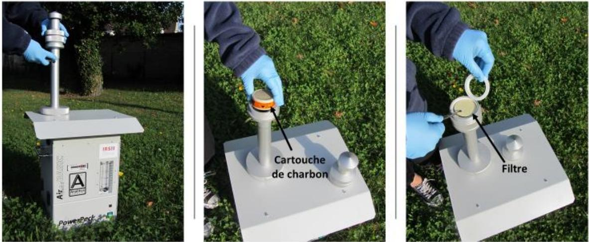
Figure II- 10- Préleveur atmosphérique pour gaz et aérosols
