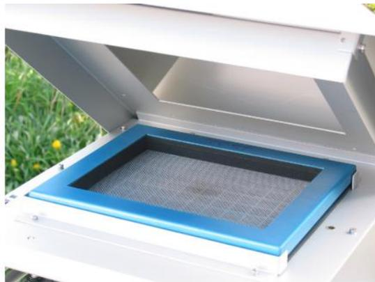
Figure IV- 3- Emplacement du filtre du HVS
