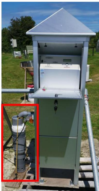
Figure IV- 5- Préleveur automatique avec colonne de prélèvement destinée au piégeage de l'iode gazeux
