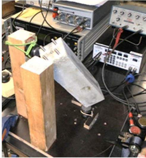
Figure 31 : Essai RUS avec l'éprouvette en équilibre sur trois appuis ponctuels dont deux sont constitués par les traducteurs ultrasonores.
