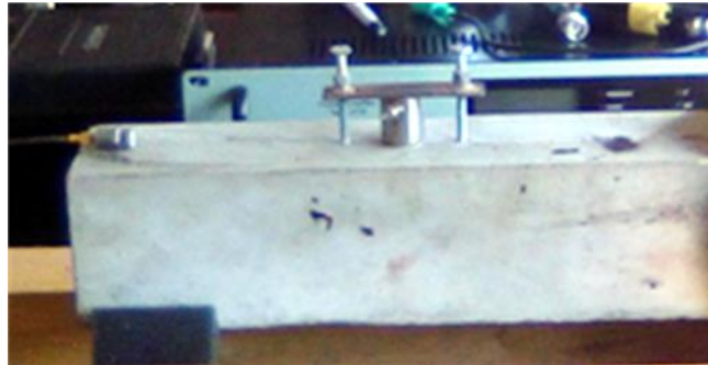
Figure 32 : Traducteur d'EA maintenu en appui par une lame élastique bandée par deux vis.
