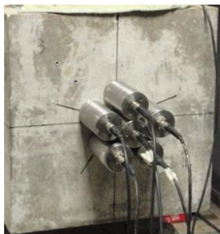
Figure 66 : Illustration du dispositif d'onde pompe. Six transducteurs 24 kHz forment une grappe circulaire.
