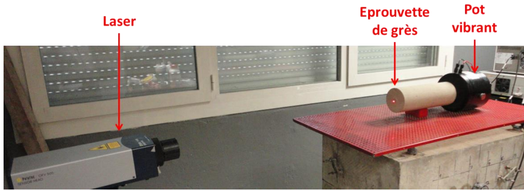
Figure 49 : Essai NRUS effectué sur la carotte de grès dans laquelle a été taillée la boule. Le pot vibrant excite l'éprouvette selon le mode de résonance longitudinal tandis que le laser mesure la vitesse particulière sur une face circulaire.
