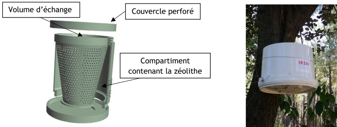
Figure 40 : a) Coupe axiale d'un piègeur passif développé par l'IRSN et b) Dispositif contenant le piège passif lors de l'instrumentation in-situ.
