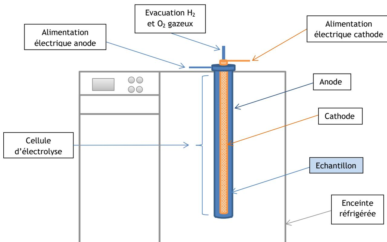
Figure 7 : Schéma représentatif du dispositif d'enrichissement électrolytique.
