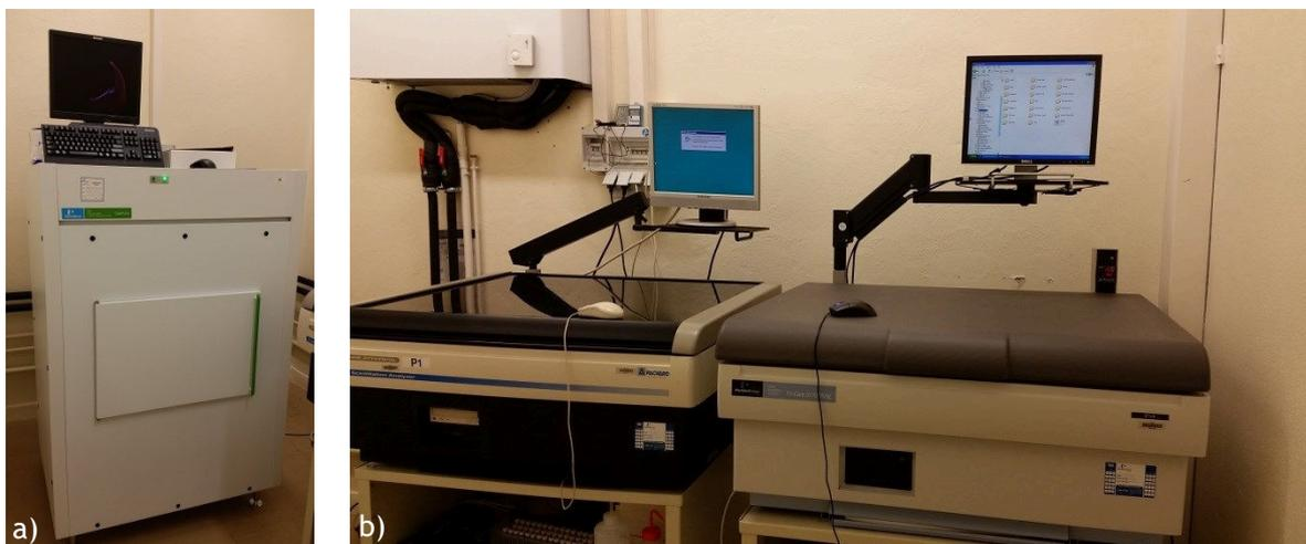
Figure 6 : Compteurs à scintillation liquide a) QUANTULUS, modèle 1220 et b) PACKARD, modèles Tri-Carb 2770TR et Tri-Carb 3170TR.
