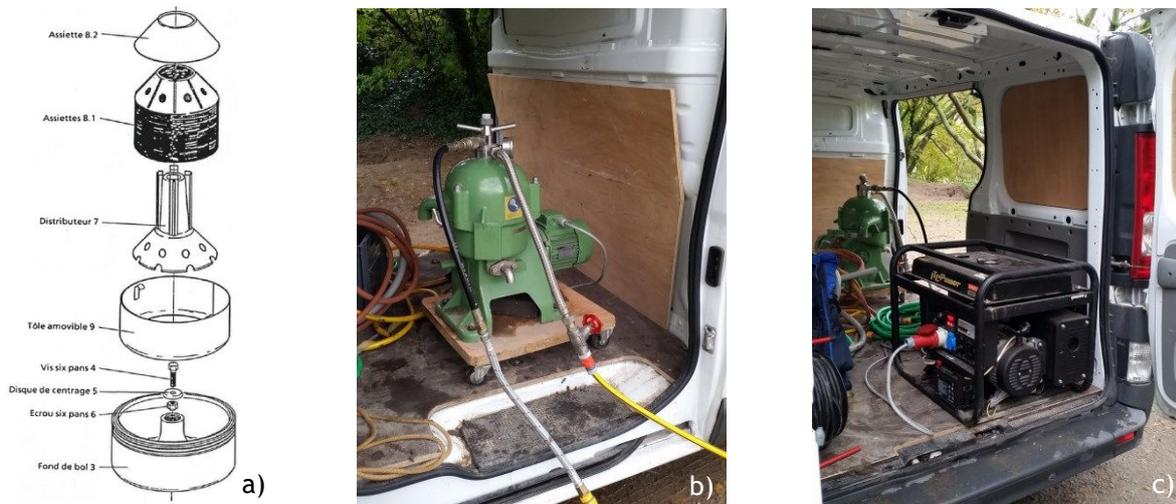
Figure 38 : a) Vue éclatée du système de rotation et de rétention des matières en suspension de la centrifugeuse, d'après Westfalia (GEA) b) Centrifugeuse c) Groupe électrogène alimentant la centrifugeuse.
