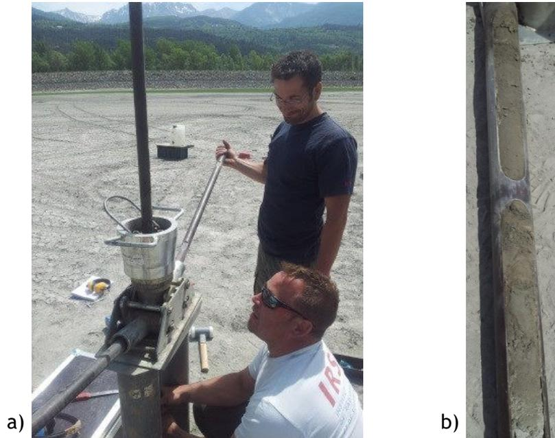
Figure 26 : Prélèvement de l'archive sédimentaire in-situ (a) et présentation d'une des sections présente dans la gouge (b)
