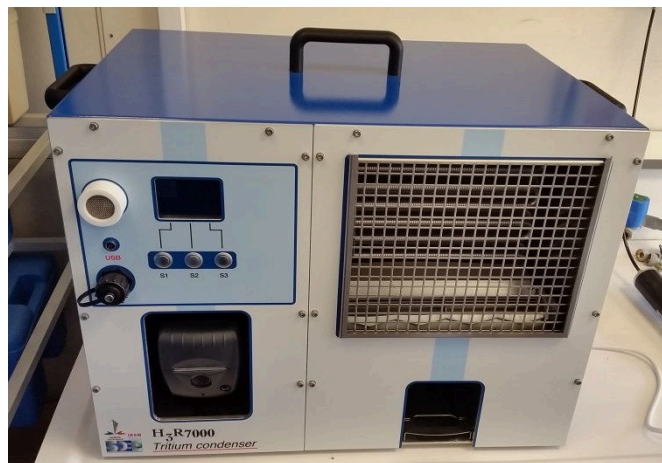
Figure 41 : Photo d'un condenseur à tritium SDEC H3R7000, utilisé dans le cadre de cette étude pour le prélèvement d'échantillons de vapeur d'eau.
