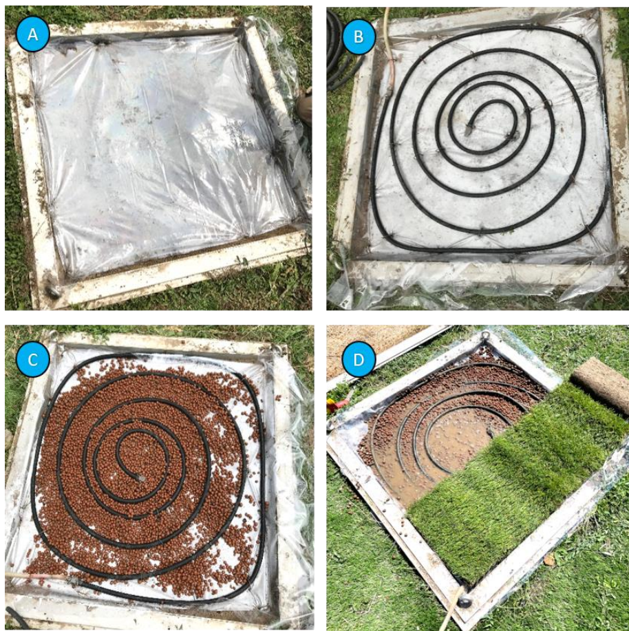
Figure II.5 : Étapes de préparation du lysimètre : (A) dépôt de la toile en plastique ; (B) disposition du tuyau d'irrigation ; (C) Disposition des billes d'argiles et (D) installation et découpe du rouleau d'herbe à chaque début de campagne.
