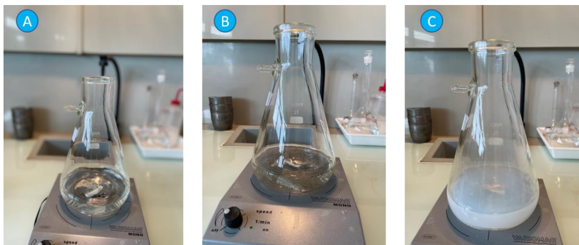
Figure II.18 : Photographies du résidu sec dissous (A) après filtration des MES ; (B) après ajout du nitrate d'argent ( \text{AgNO}_3 ) ; (C) après ajout de l'acide nitrique ( \text{HNO}_3 ).
