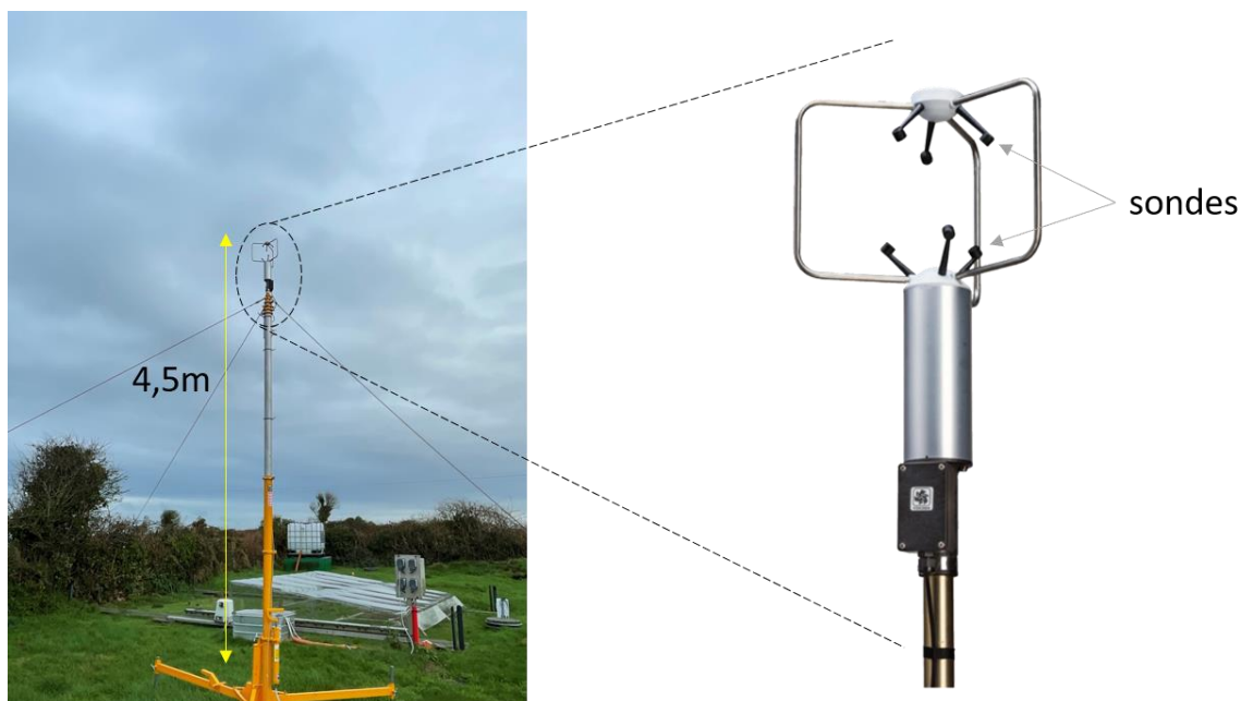
Figure II.11 : Photographie de l’anémomètre ultrasonique (Young 81000V) sur le site d’étude.
