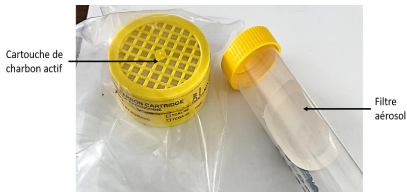
Figure II.14 : Conservation des prélèvements atmosphériques.
